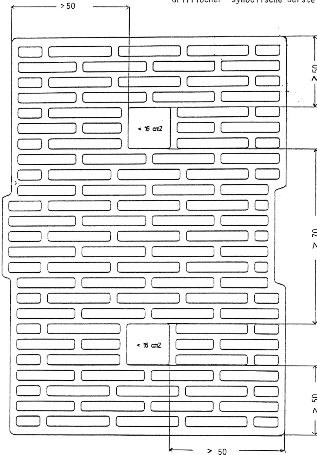
Mauerwerk aus THERMOPOR ISO-Plan-Deckel-Ziegeln
